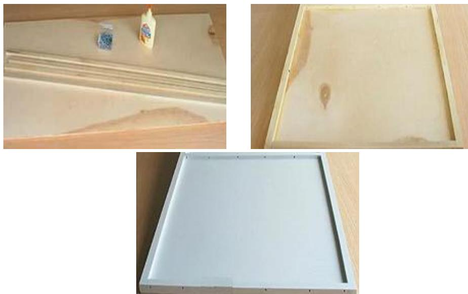
*La fase di realizzazione e verniciatura della struttura in legno con cornice che alloggerà le celle solari.*
