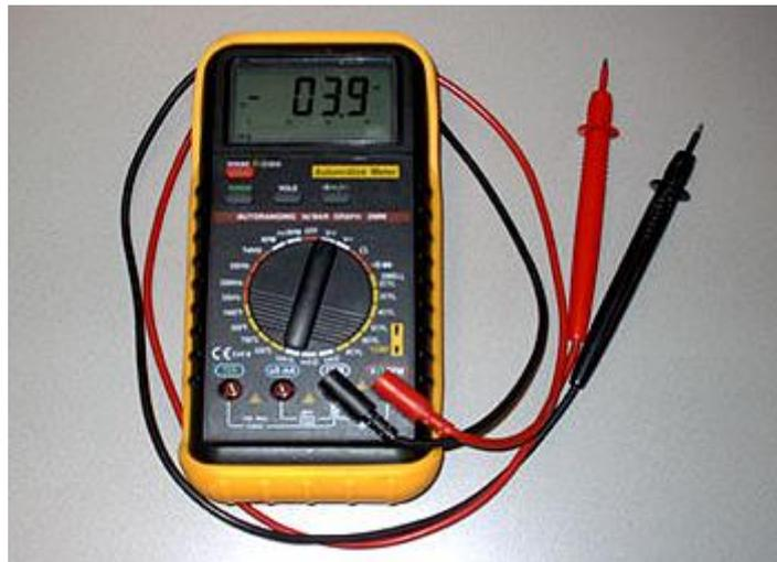
*Un moderno tester digitale che permette di compiere buone misure di tensione, corrente, resistenza, etc.*
