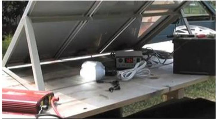
*Il risultato finale: un pannello fotovoltaico in grado di alimentare una lampadina o altri carichi di uso comune, oppure di caricare una batteria.*
